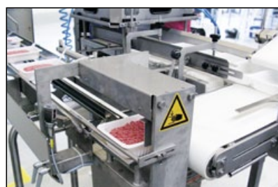
◀ Beispiel einer Installation mit Schalenentstapler und Übergabeeinheit auf das Zuführband der Linus.
