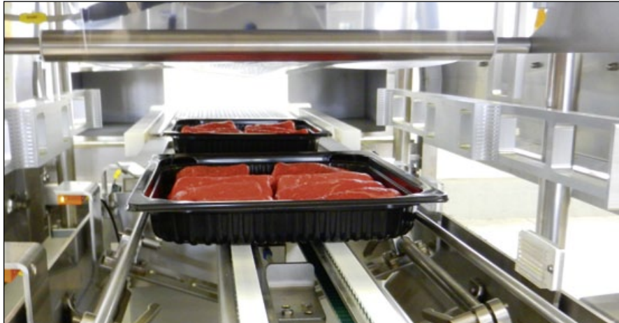
Tray-Übergabe an Siegelstation über Zangeneinheit
